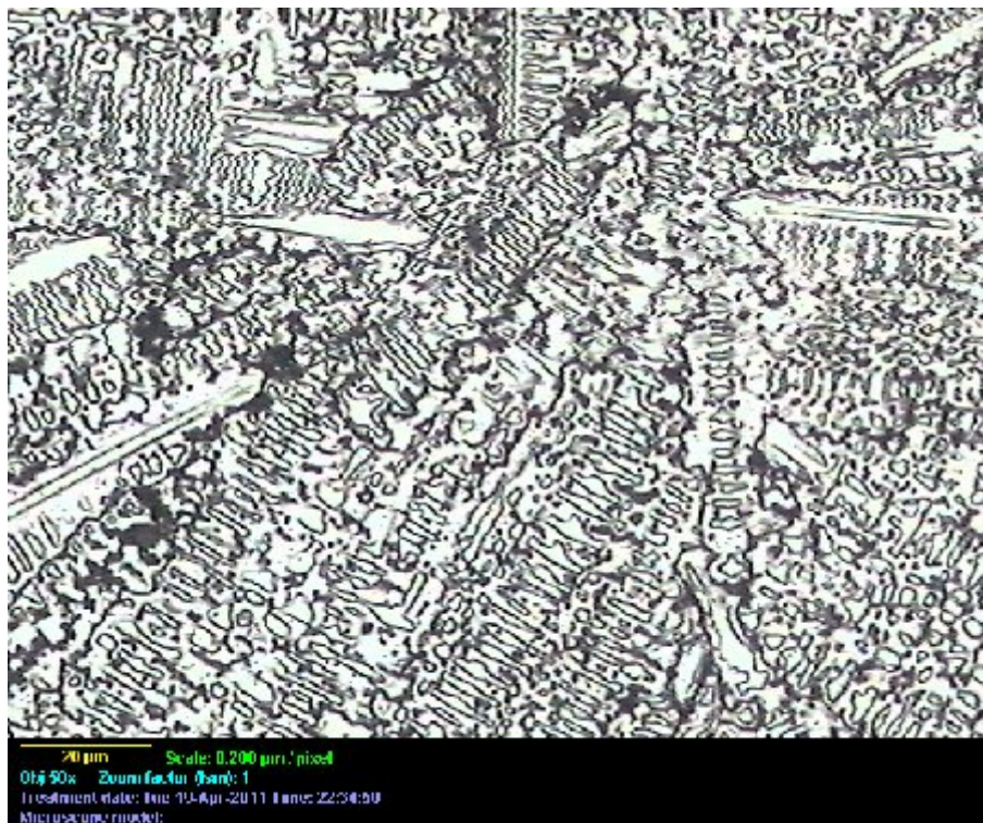
Figure IV.2 : Microstructure Du Wironit (Co-Cr) après attaque chimique.
