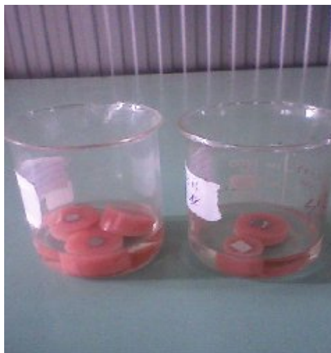
Figure III.8 : échantillons immergés dans une solution physiologique.
