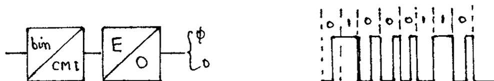
Fig 3.12.a Principe du mode CMI
