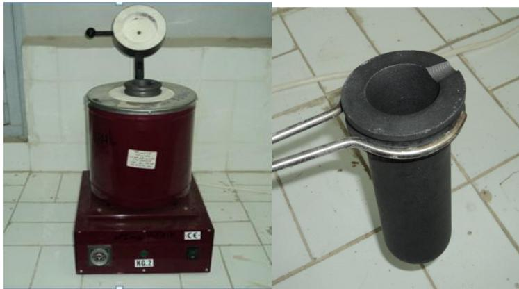
**Figure III. 4.** Four de galvanisation **Figure III. 5.** Creuset de four de
