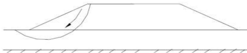
Figure.4.2. Rupture rotationnelle.
