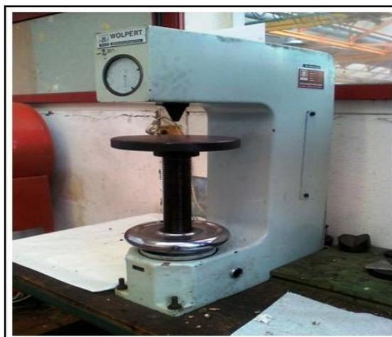
Figure 24. Machine d'essai Rockwell de type Testor HT2000.
