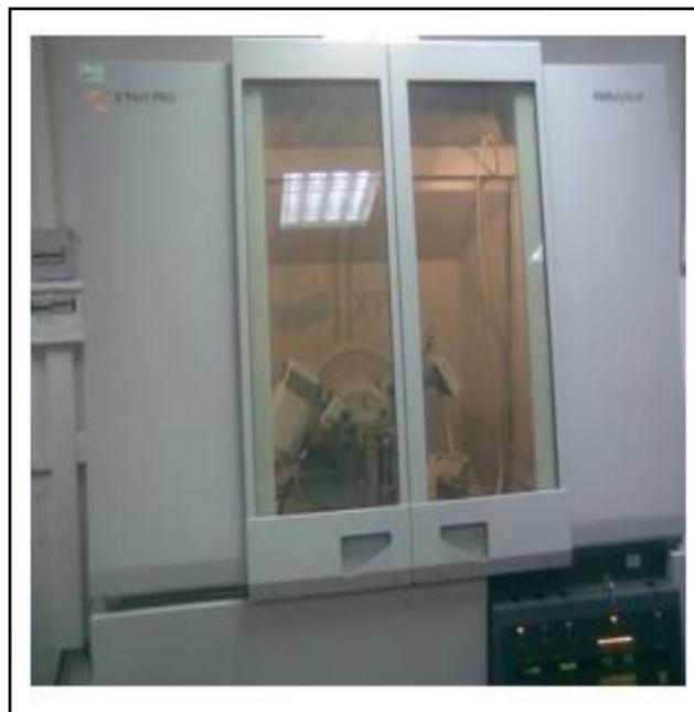
**Figure 26.** Diffractomètre de type X'Pert PRO.
