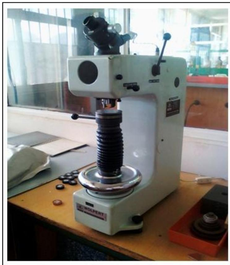
**Figure 22.** Machine d'essai Rockwell de type V-Testor 2 WESTERN.
