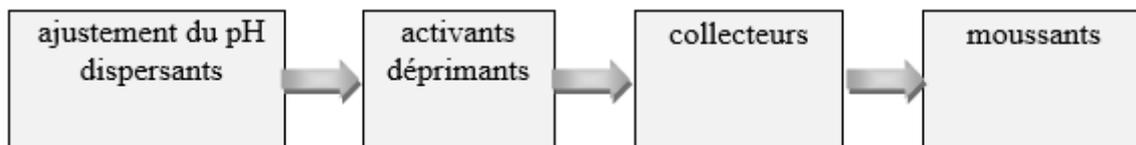
FIGURE 4.7 – Ajout des réactifs de flottation durant la préparation de la pulpe.
