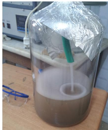
FIGURE 4.13 – Calcination de  $\text{ZnS}$  et dégagement de  $\text{SO}_2$
