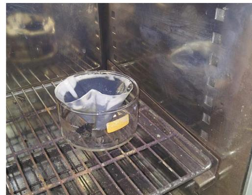
FIGURE 4.22 – Filtration et séchage du précipité de zinc
