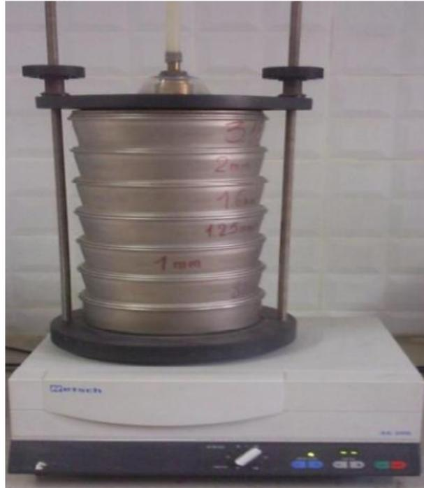
FIGURE 4.3 – Tamiseuse de type Retch
