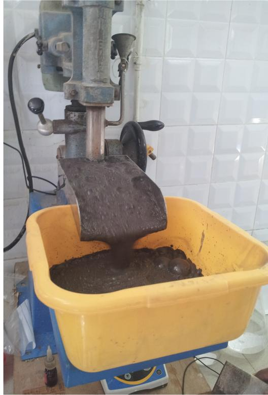
FIGURE 4.6 – Cellule de flottation (DENVER)
