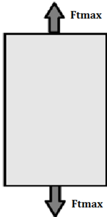
Figure I.6 : le principe de la traction directe
