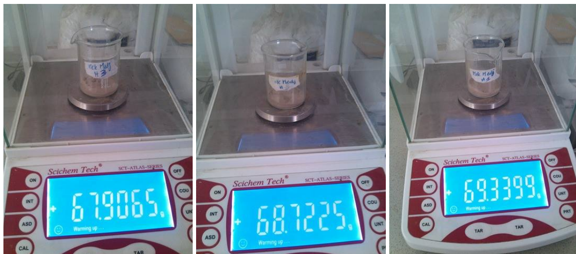
FIGURE 6.6 – Images illustrant les résultats des essais de détermination de la teneur en eau de l'échantillon n° 2 de Boucaïd
