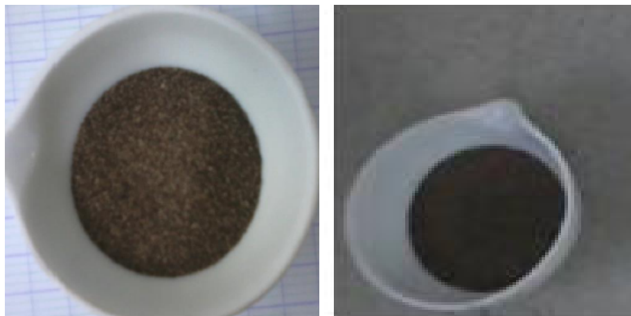
FIGURE 6.5 – creuset contenant le minerai avant (à gauche)\après (à droite) calcination à 375°C
