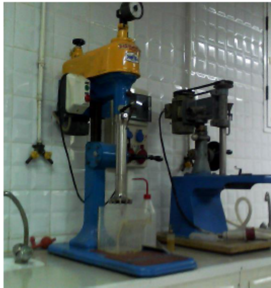
FIGURE 7.1 – Cellule de flottation DENVER utilisée lors de nos essais
