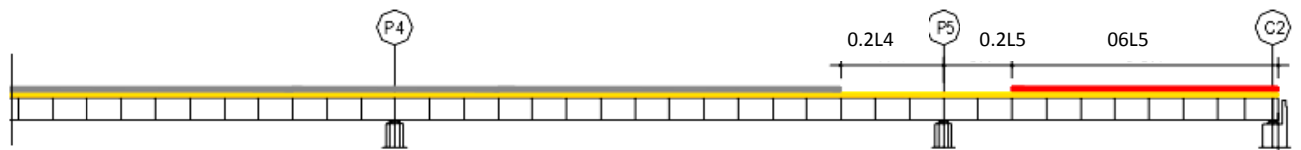
Fig. V. 10. Coulage de la dalle dans les travées p_5 - C_2 .
