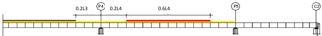
Fig. V. 8 . Coulage de la dalle de la travée P_4 - P_5 .
