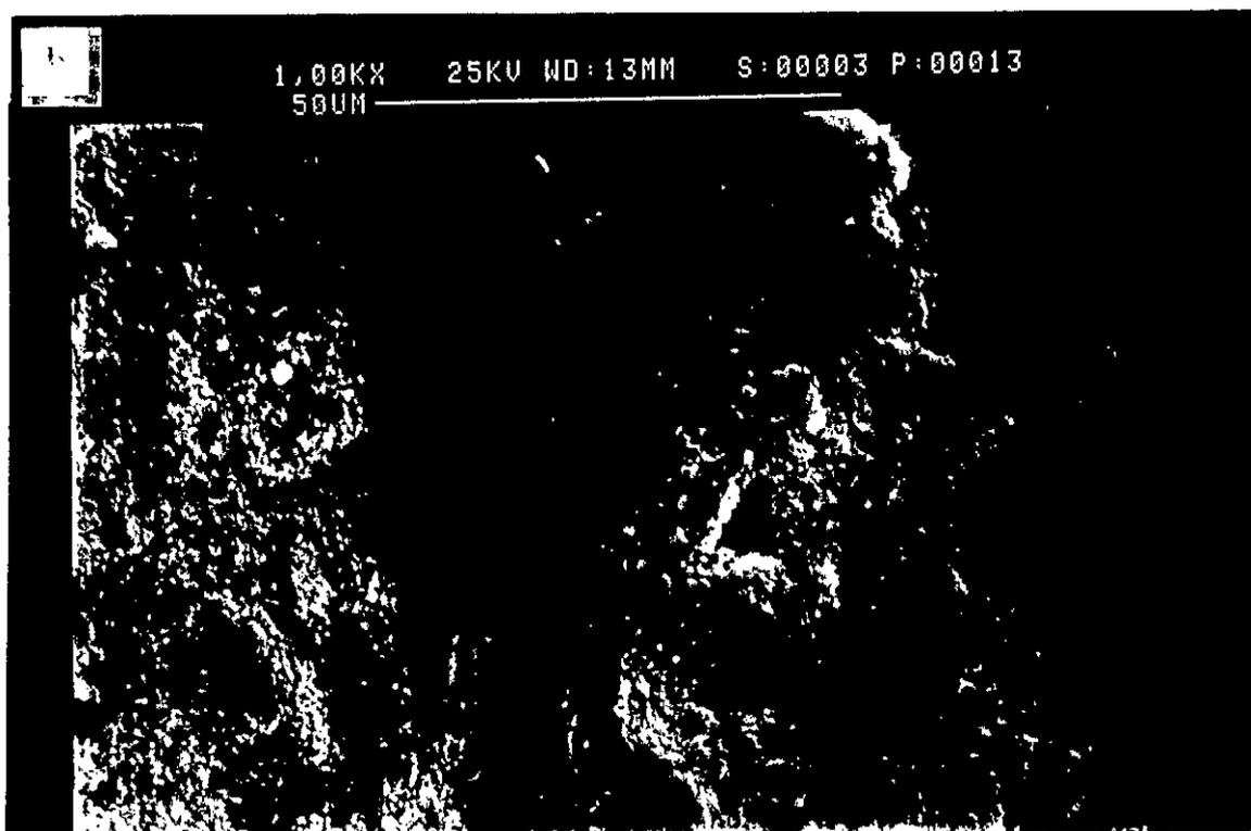
**Figure IV-39:** Traces d'usure et formation des débris après frottement à sec.
