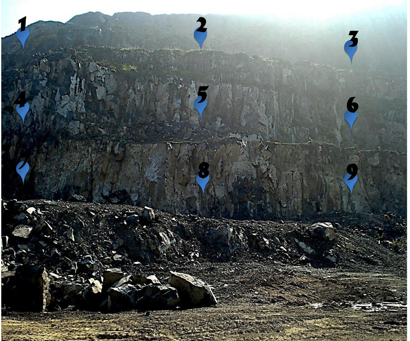
**Figure 10** : points de prélèvement des échantillons à partir des gradins de la carrière.
