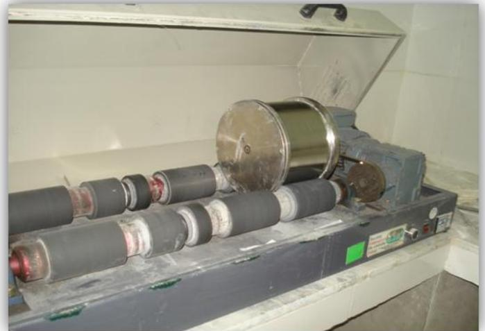
**Figure 17:** Dispositif de la machine Micro Deval
