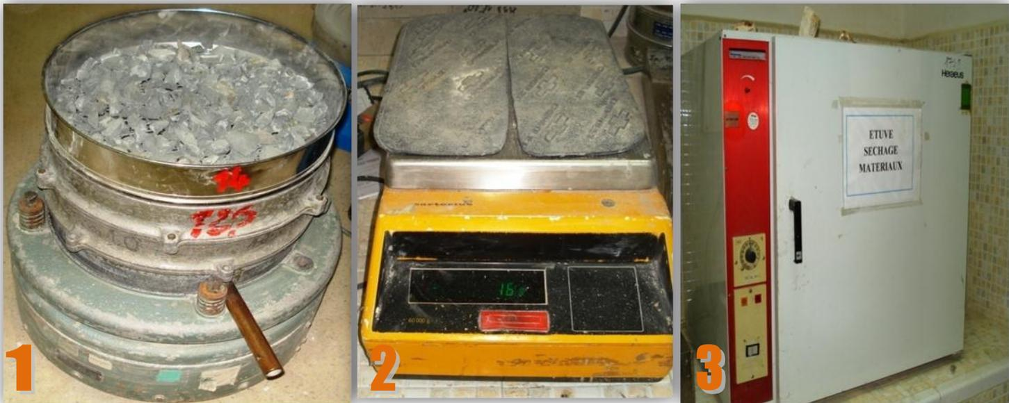
Figure 16 : Quelques matériels utilisés pour l'essai Los Angeles
