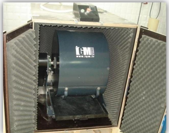
Figure 15 : Le dispositif de la machine Los Angeles
