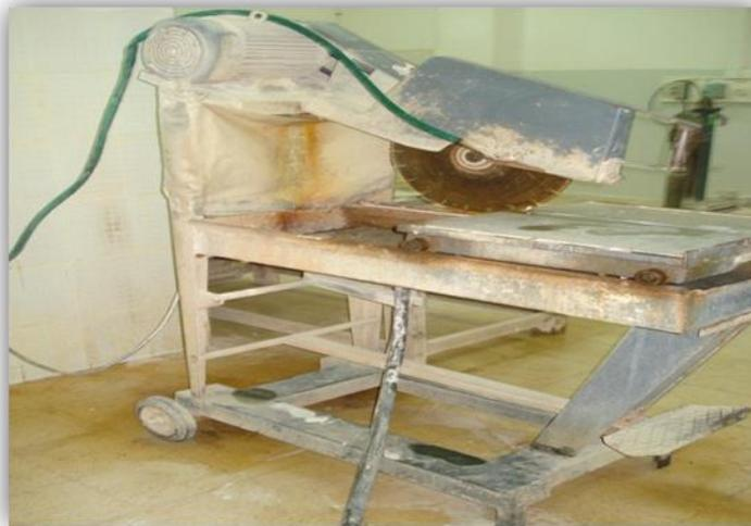
**Figure1** : Scie circulaire diamantée
