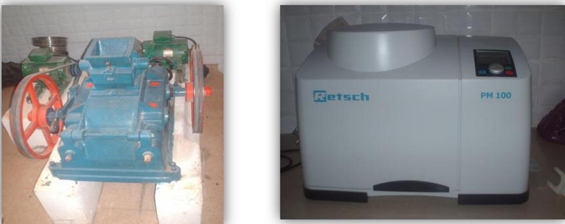
**Figure 2** : broyeur à cylindre (à gauche), broyeur à billes (à droite).
