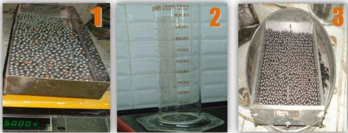
**Figure 18:** Quelques matériels utilisés pour l'essai Micro Deval
