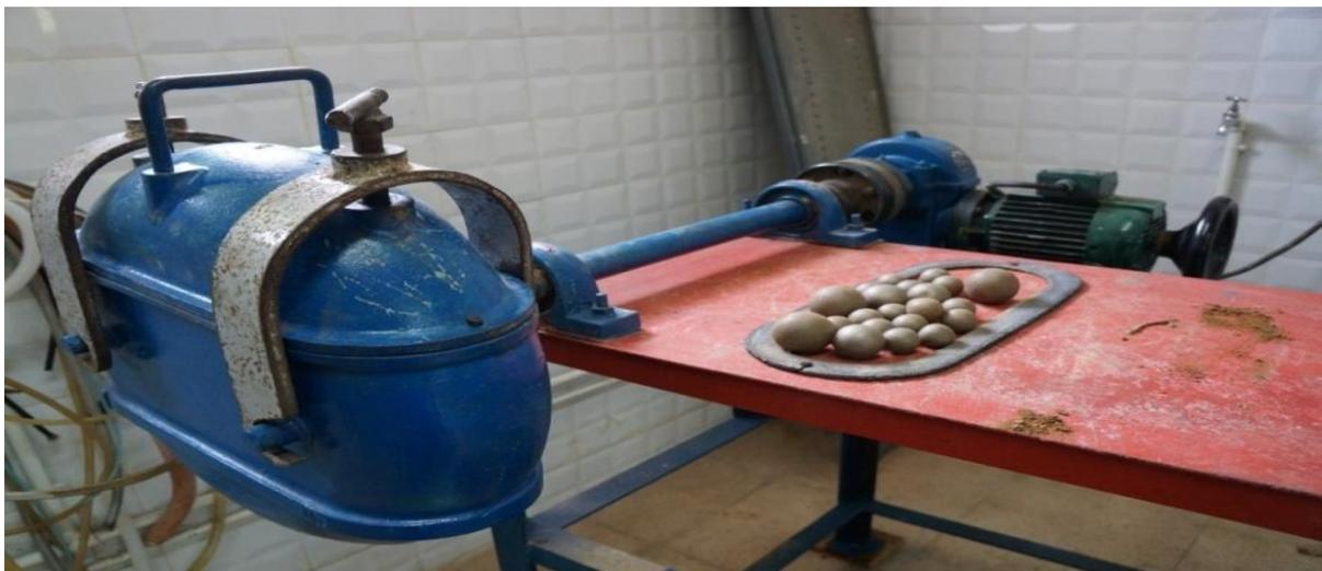
*Figure I.1. broyeur à boulet et boulets utilisée*
