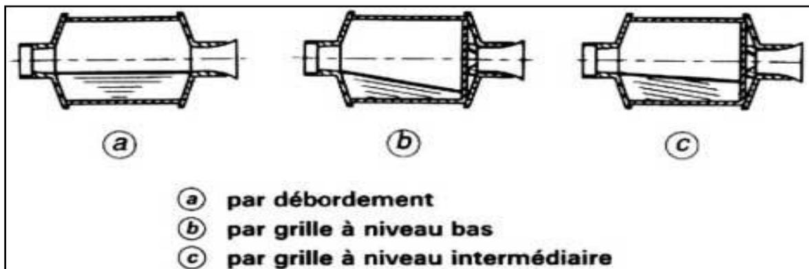
Figure I.4. Systèmes de décharge des broyeurs à boulets (D'après SME Minéral Procéssing)
