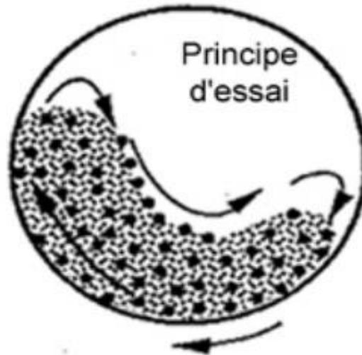
**Figure II.12 : principe de l'essai de M.D.E**
