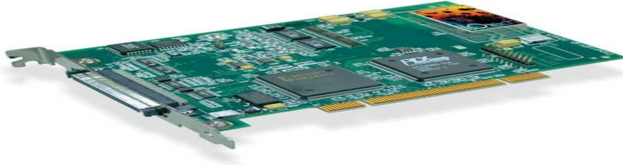
Figure II.4 : Vue de la carte d'acquisition DaqBoard/1005.
