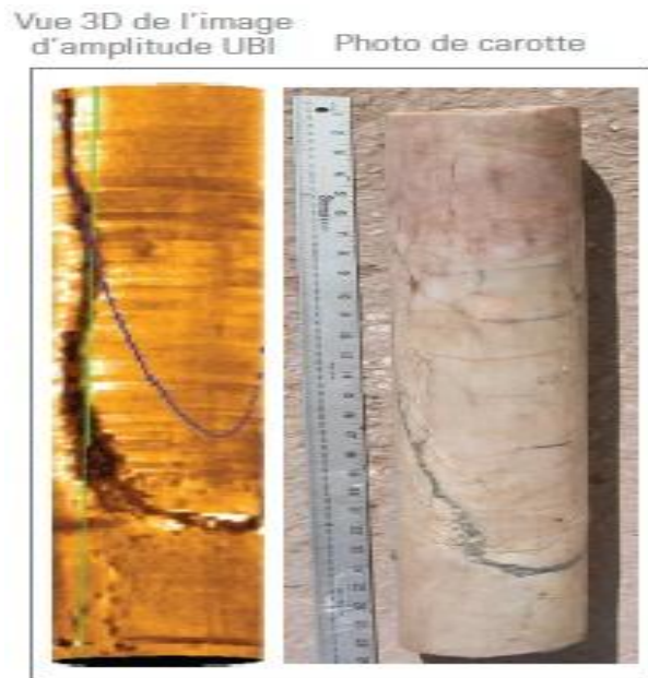
Fig. IV.2 : Vue 3D issue de l'imagerie UBI en comparaison avec l'échantillon de carotte, (Document Schlumberger).
