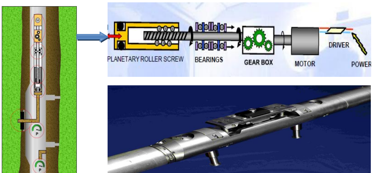
Figure V.1. XPT (Xpress Pressure Tool), mécanisme de fonctionnement
