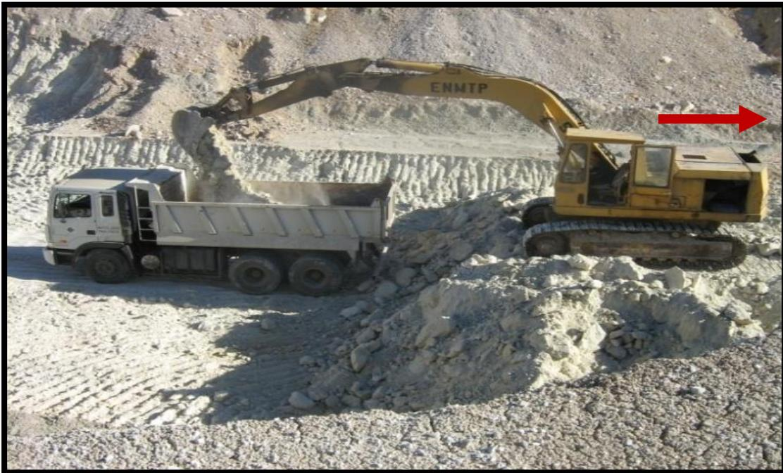
**Figure V.13** : Système de chargement du minerai après l'exploitation de la première phase. [16]
