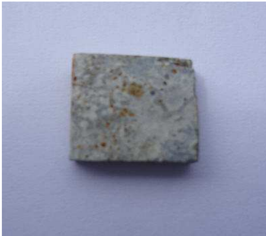
Figure 22. Essai de corrosion pour 40 heures.
