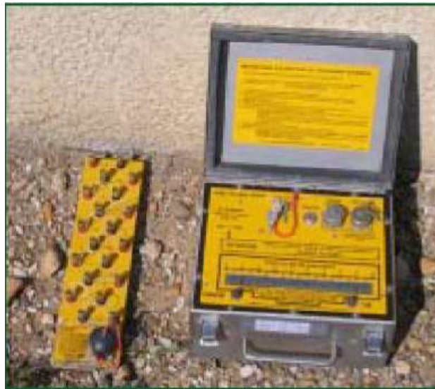
Figure III.5 : Exploseur séquentiel BM-20 F-10 PT.
