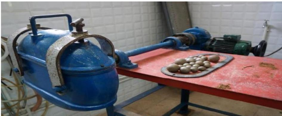
Figure IV:3 : Broyeur à boulets
