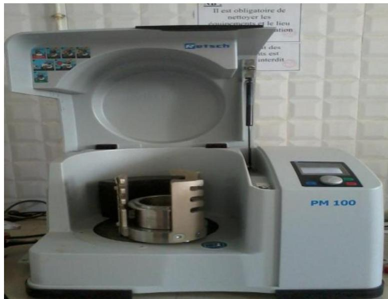
Figure IV:4: Broyeur à billes
