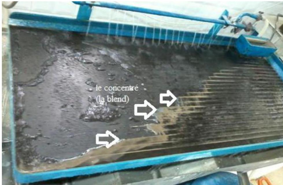
Figure IV:12 : Essai de la Table à secousses lorsque le débit d'eau moyen
