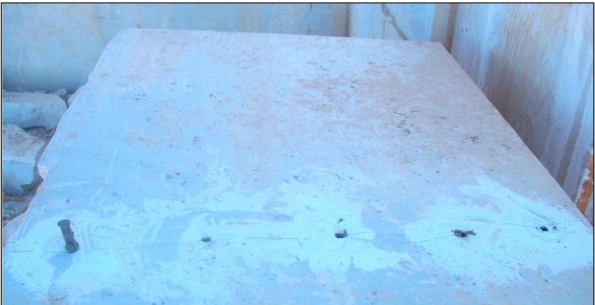
**Fig. III- 13 :** Débitage des masses par forage et coins.
