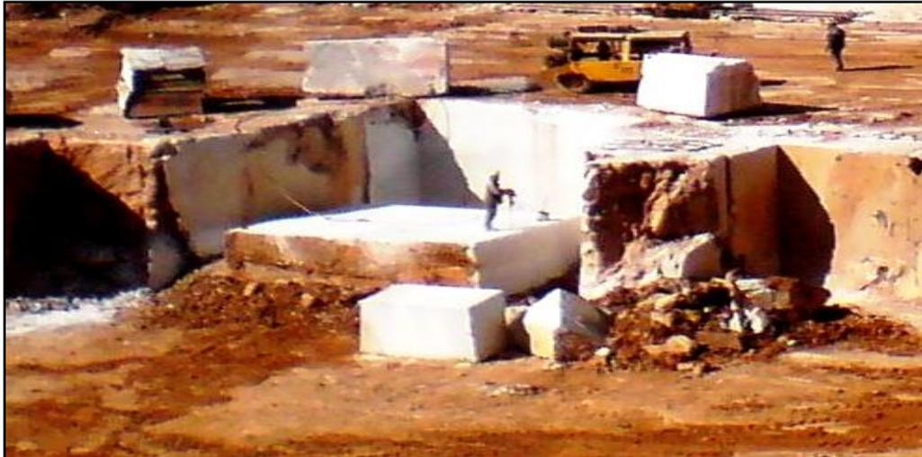
**Fig. III- 11 :** Culbutage de la masse.
