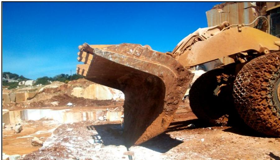
Fig. III- 10 : Renversement de la masse a l'aide du trax.
