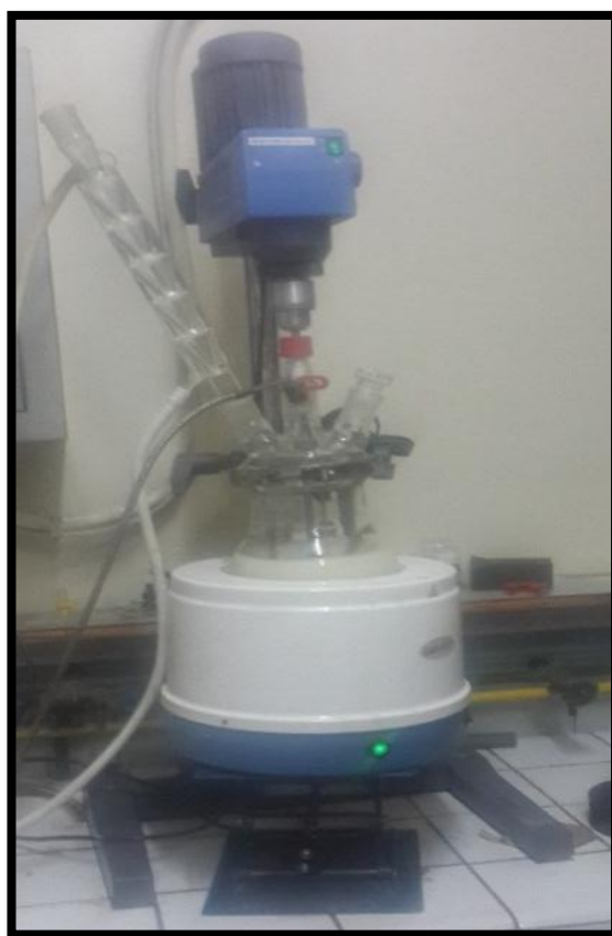
Figure V - 4 : Dispositif expérimental de l'activation à l'HCl
