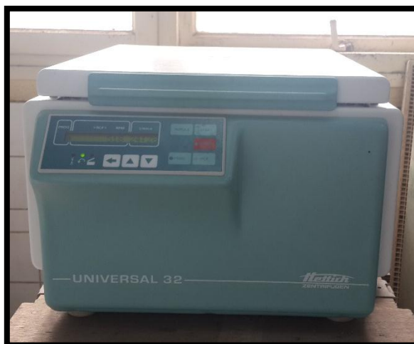
Figure V - 11 : Centrifugeuse Hettich Universal 32
