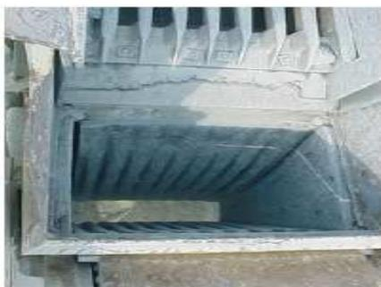
Figure II.2 - Concasseur à mâchoires à simple effet
