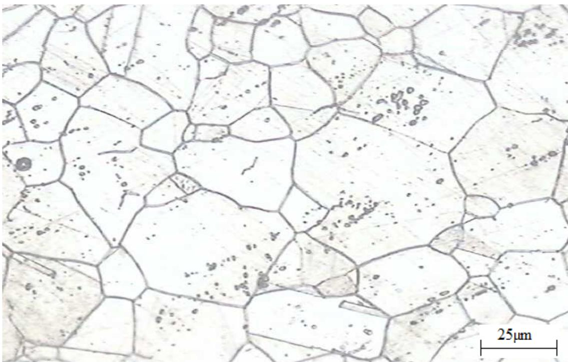
*Figure V.8. Attaque électrolytique Acide Oxalique G x 200.*
