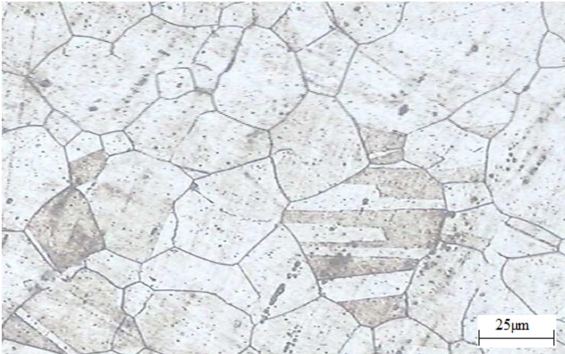
*Figure V.7. Attaque électrolytique Acide Oxalique G x 200.*
