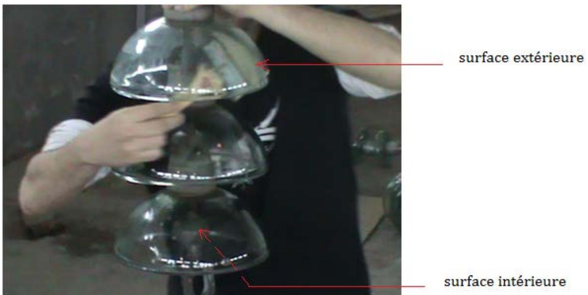
**Figure II.2 :** Méthode d'application de la pollution non-uniforme.
