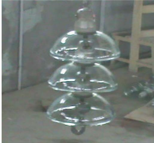
**Figure II.2 :** Chaîne d'isolateurs réels U120B étudiée.
