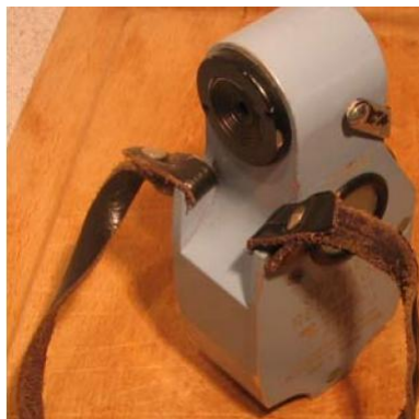
Figure 5 : Relascope de Bitterlich [Réf 2]
