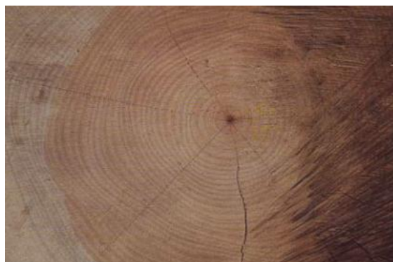
Figure 10 : Mesure des anneaux de croissance sur une coupe transversale de tronc d'okoumé [Réf 2]
