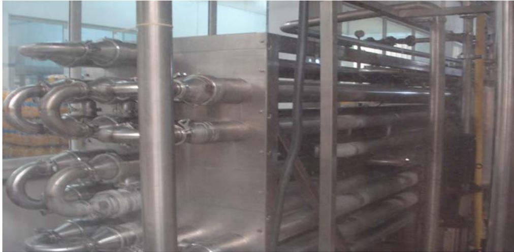
**Figure IV.1.** Pasteurisateur multitubulaires (photo prise sur site)
