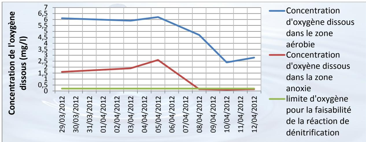
**Figure VIII.6:** Evolution de la concentration d'oxygène dissous dans la zone aérée et dans la zone anoxie du réacteur biologique du 29/03/2012 au 12/04/2012 pour la STEP de Rghaia.
