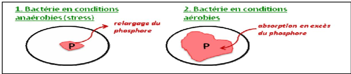
**Figure IV.12:** Représentation schématique du stockage ou de l'utilisation du phosphore par les bactéries en fonction du milieu [33]
