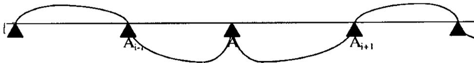
Figure III-2 Allure de la ligne d'influence du moment sur appui "i"
