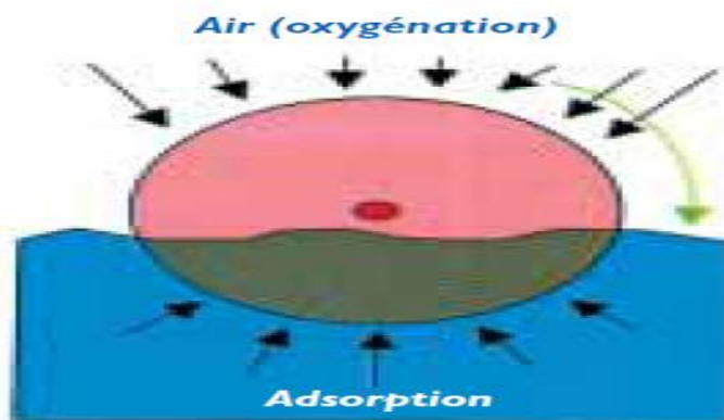
Figure II.11 : Schéma du principe d'un disque biologique [4]
