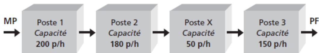
Figure 2-7: Ligne de production avec capacité de production. (Maurice PILLET, 2011)
