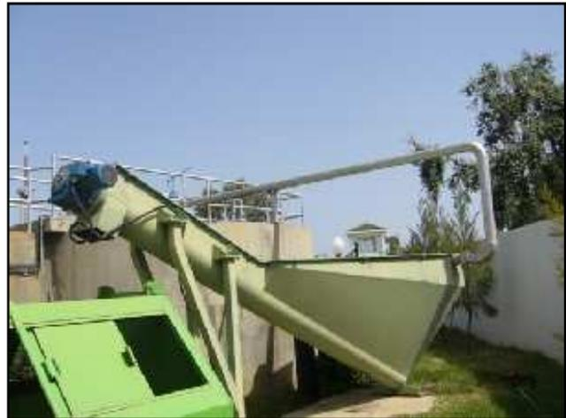
**Figure V-5 : Classificateur de sable**
