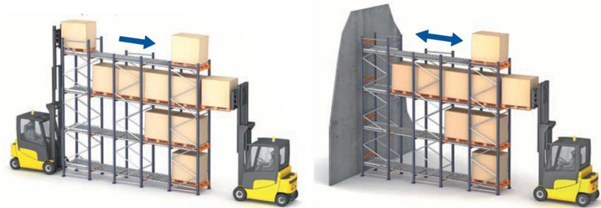
Figure II.10 - Système classique et Push-back (Mecalux)
