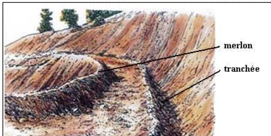
Fig.4.9 : Banquette en préparation avec merlon aval et tranchée amont.
