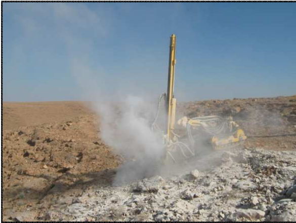
Fig.2.9 : émission de poussière par foration des trous de mines.
