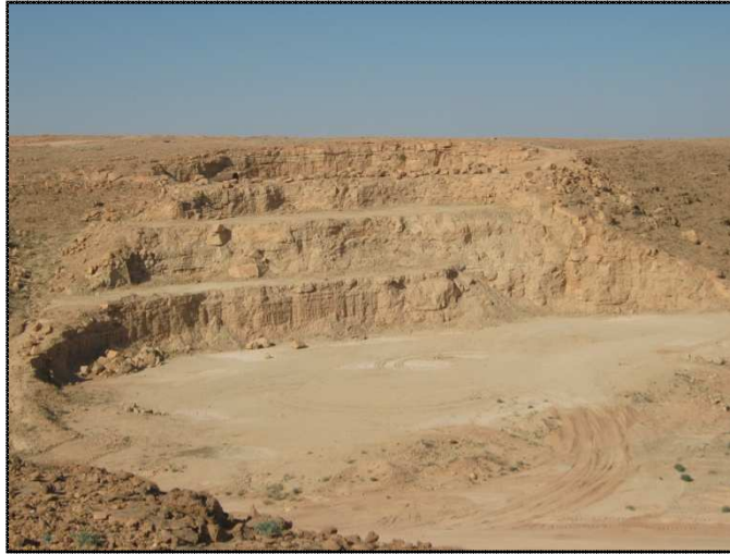
Fig.4.7: la forme d'une excavation dans une carrière à ciel ouvert en Algérie.
