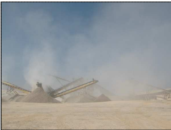
Fig.2.11 : émission de poussières par station de concassage.
