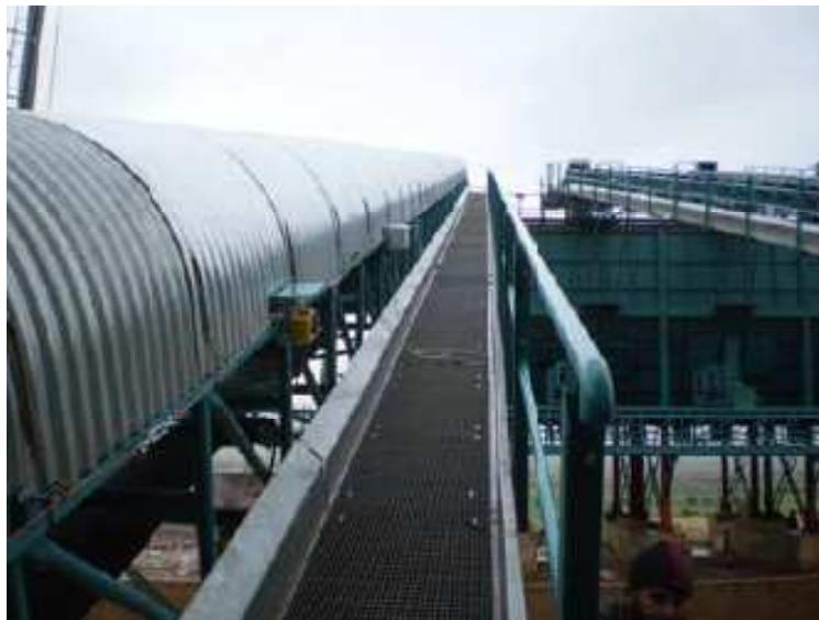
Fig.4.4: Capotage des convoyeurs (AZREUG .M ,2009).
