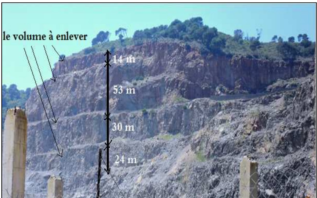
Figure 4.20: Hauteurs des gradins en fin d'exploitation du site Nord (gradins en liquidation).
