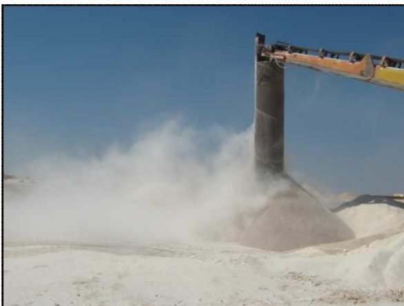
Fig.2.13 : émission de poussière par les stocks (action du vent).
