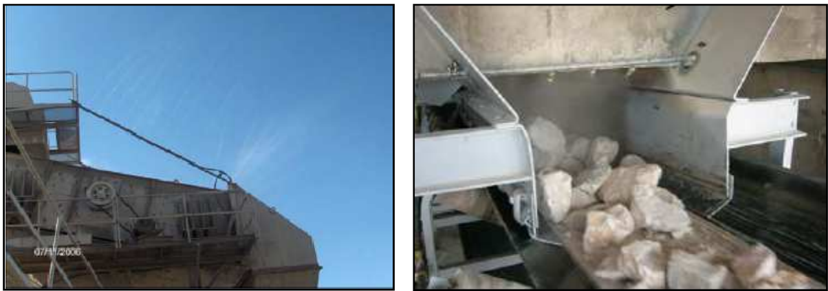
Fig.4.1: Abattage des poussières par pulvérisation d'eau (AZREUG .M ,2009).
