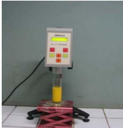
**Figure n°10:** Viscosimètre Brookfield LV-I+
