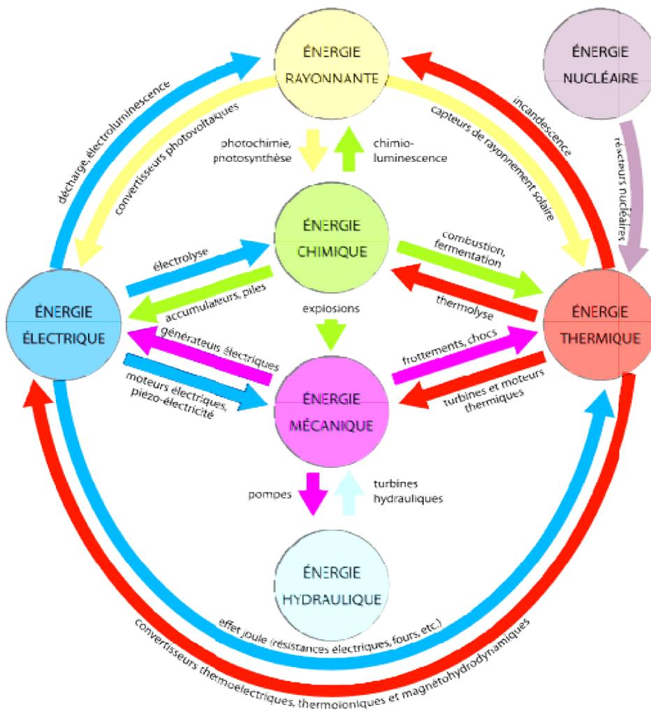
**Figure. I.3.**Conversions des principales formes d'énergie et quelques exemples de convertisseurs d'énergie.
