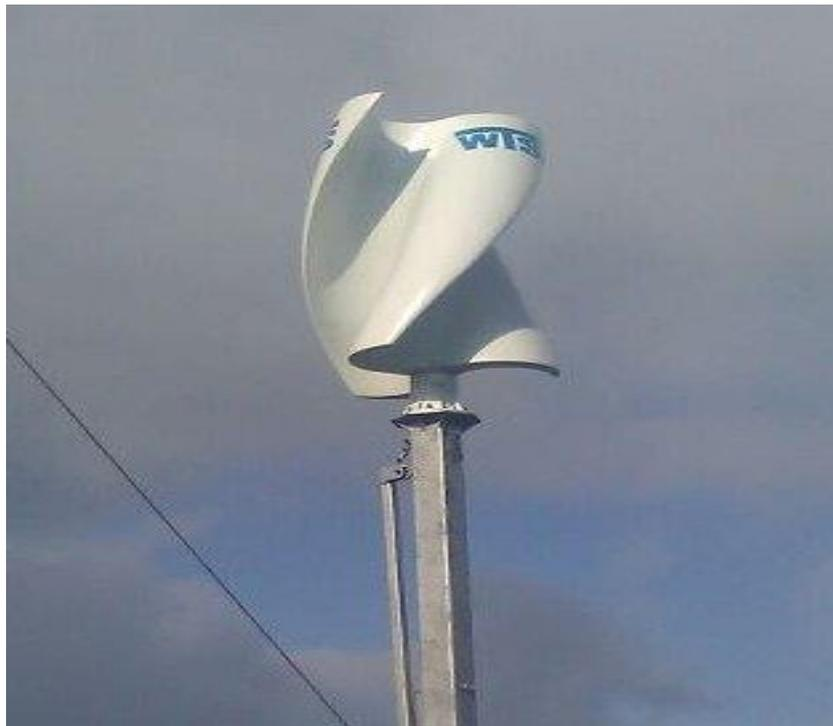
Figure 2-3 : Eolienne savonius hélicoïdale
