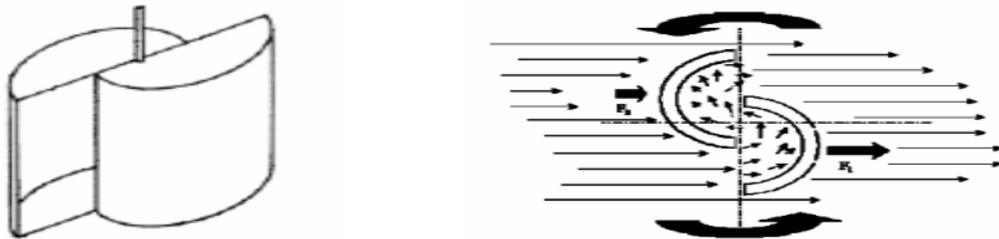
Figure 2-4 : Force et rotation de l'éolienne [8]
