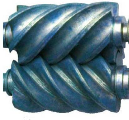
**Fig.2.3 :** Compresseur bi-vis[7].
