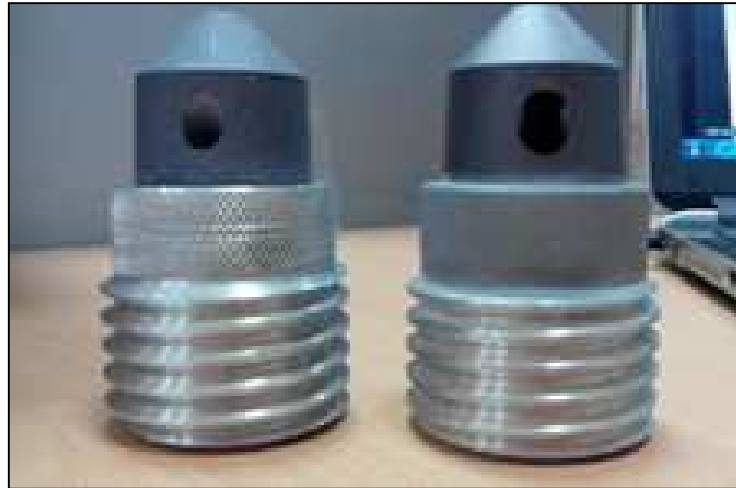
Figure IV.2 : Une buse de projection angulaire objet de notre étude
