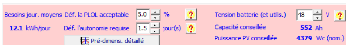
Figure II.7: La puissance du panneau et la capacité de la batterie conseillées.
