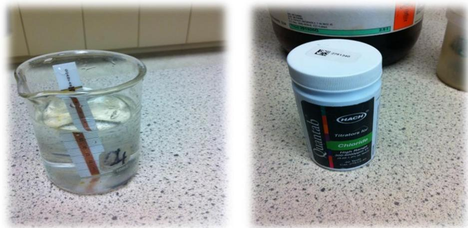
Figure 6 : Titrateur de chlorure (stage Schlumberger, 2015)
