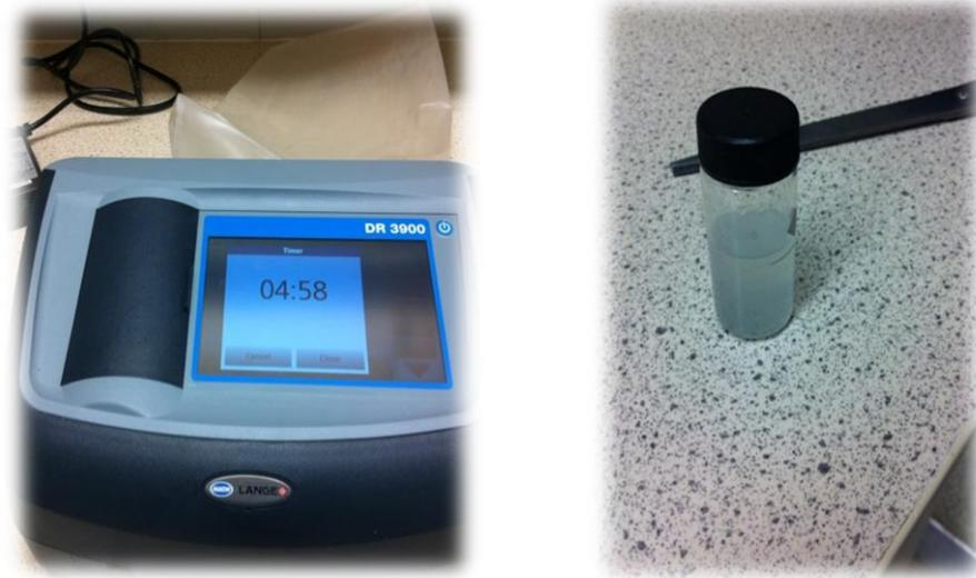
**Figure 7** : Spectrophotomètre et un flacon contenant l'eau avec le Sulfaver (stage Schlumberger, 2015)
