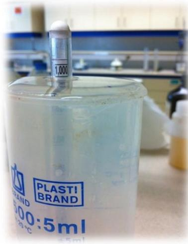
**Figure 4 :** Hydromètre (stage Schlumberger, 2015)
