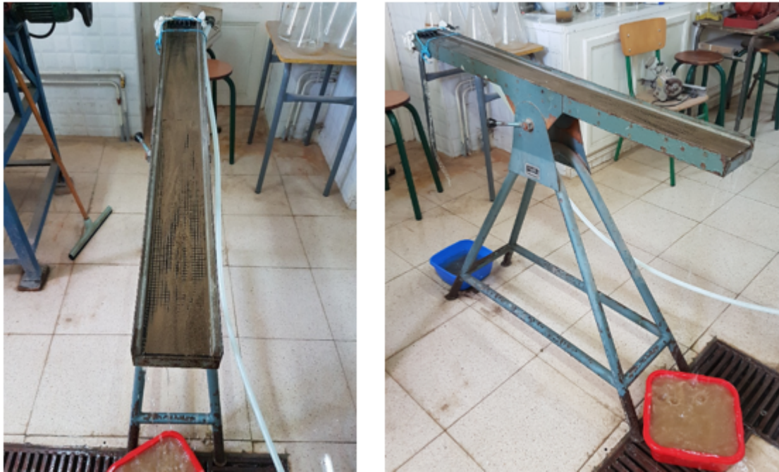
FIGURE 3.1: Séparation gravimétrique par le couloir alluvionnaire
