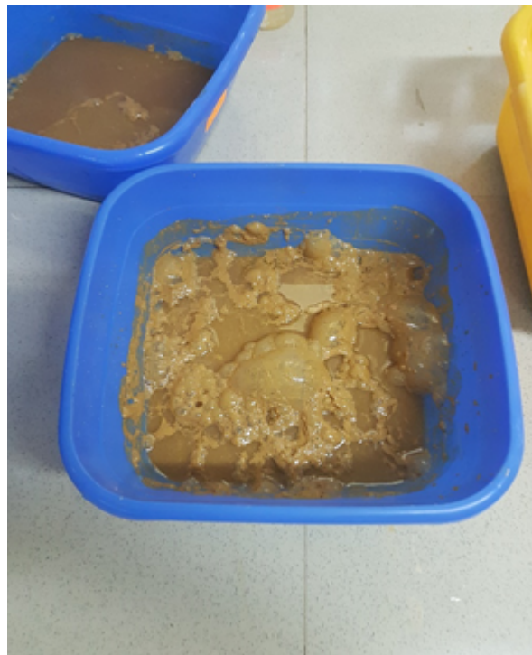
FIGURE 3.4: concentré sulfuré obtenu par flottation
