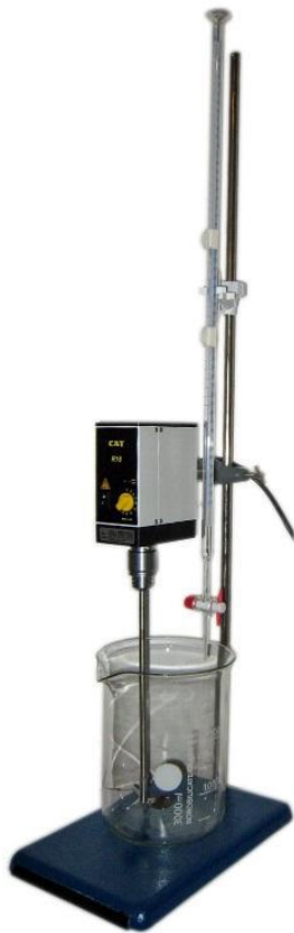
Figure. II. 3:l'appareillage de l'essai au bleu de méthylène.
