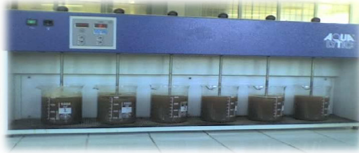
Figure 27: Flocculateur utilisé pour l'optimisation des paramètres de coagulation floculation.
