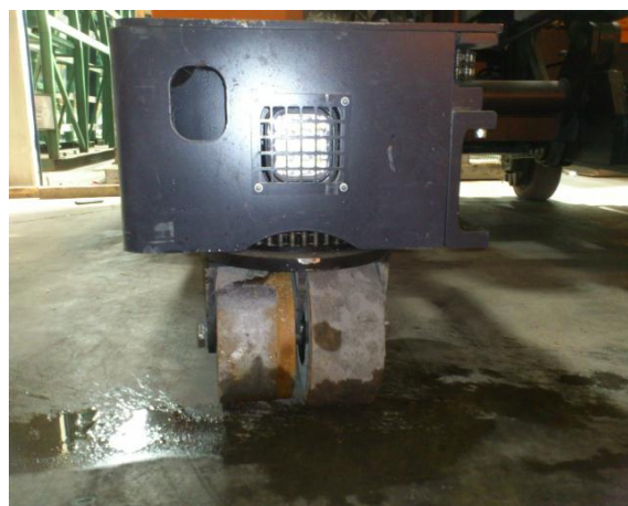
Figure IV. 4 État de Roues dégradé (le transpupitre)
