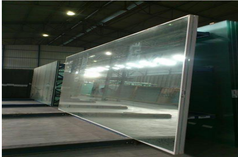
Figure I. 9 Piles de MEDISTAR+S (exemple de verre à couche)
