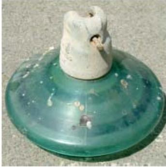
Figure 3. 7 Isolateur à profil antibrouillard N° 14 taché par la peinture.
