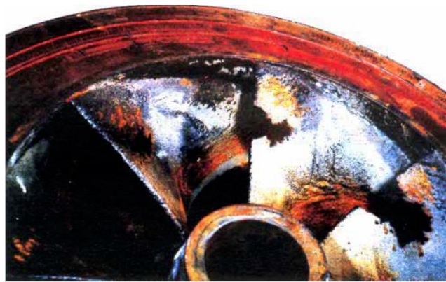
FIGURE 1.4: Érosion par cavitation d'une roue centrifuge [19]
