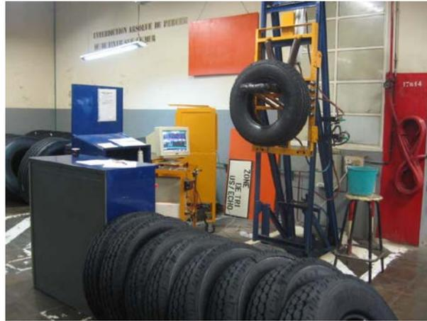
Figure II.7 : Contrôle ultrason des pneus
