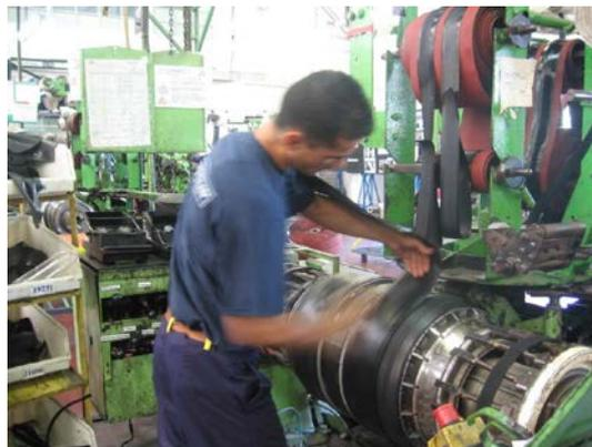
**Figure II.4 :** Assemblage d'un pneu
