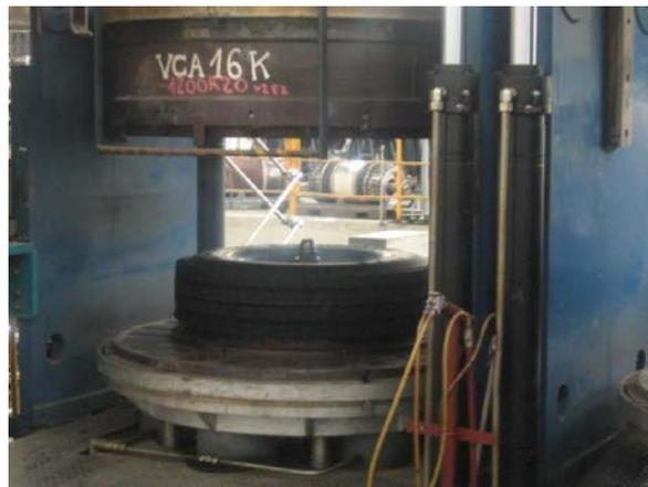
**Figure II.6** : Cuisson d'un pneu dans une presse
