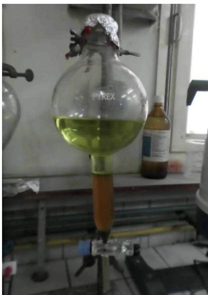
**Figure II-3 :** Dispositif de l'extraction liquide-liquide par éther de pétrole
