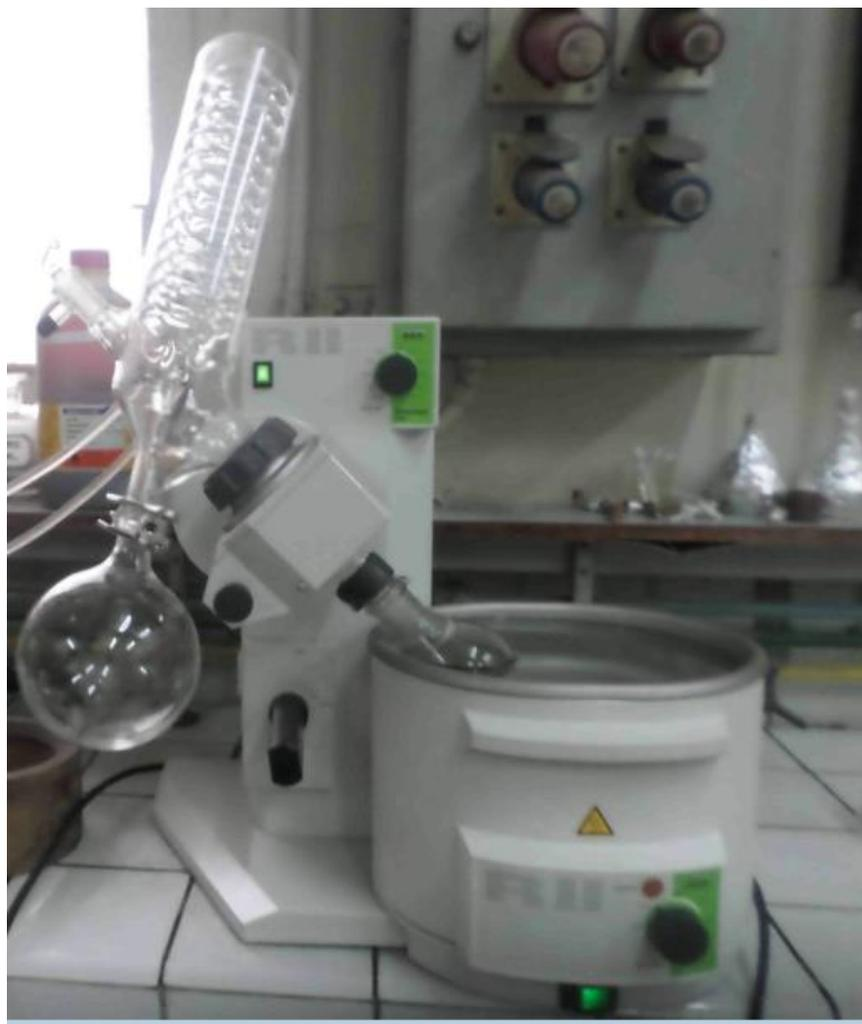
**Figure II-2 :** Photo de l'évaporateur rotatif
