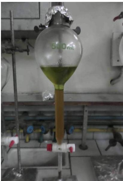
**Figure II-4 :** Dispositif de l'extraction liquide-liquide par acétate d'éthyle
