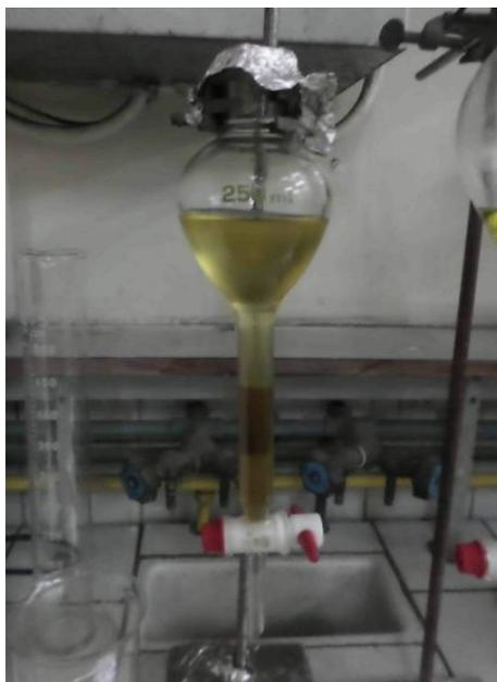
**Figure II-5 :** Dispositif de l'extraction liquide-liquide par MEC
