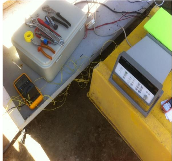
Fig.4.6.14 Lecture de la température sur le data logger Fluke
