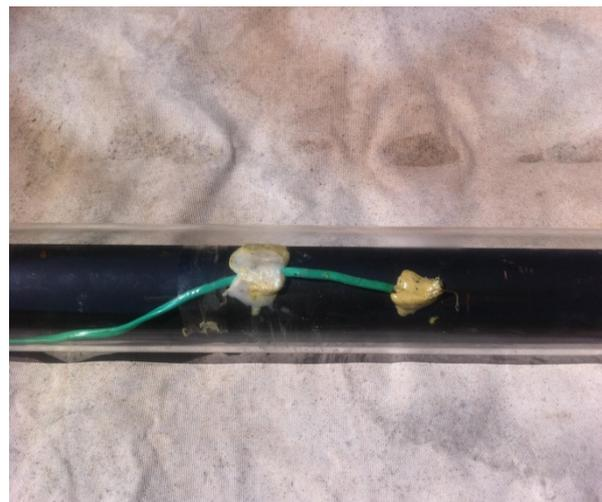
Fig. 4.6.12 Fixation des Thermocouples du type K sur l'absorbeur
