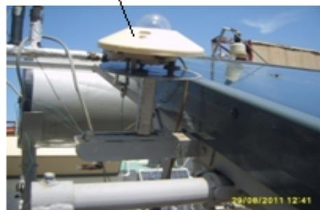
Fig. 3.2.16.f Mesure le l'éclairement de l'éclairement global incident sur le collecteur
