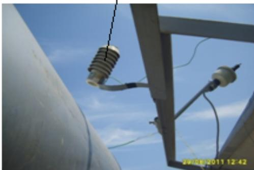
Fig.3.2.16.e Mesure de la température ambiante
