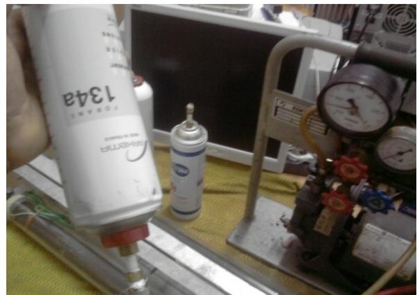
Fig. 4.6.10 Remplissage du fréon R134a
