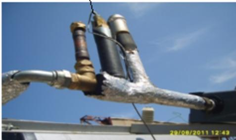
Fig.3.2.16.c. Mesure de la température de sortie du collecteur
