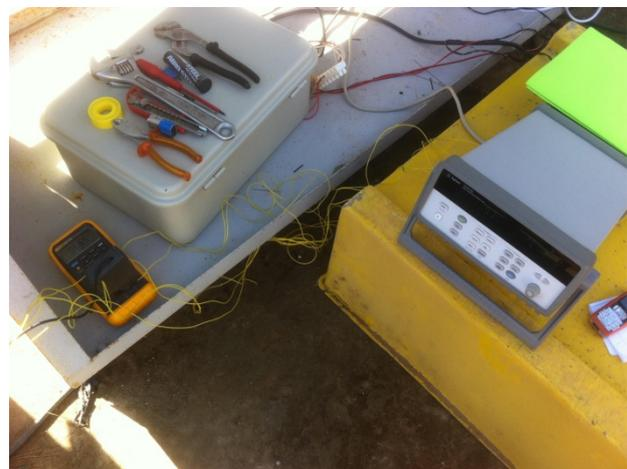
Fig. 4.4.4 Enregistrement des données sur l'acquisition de données (Gelante) à 40 voies
