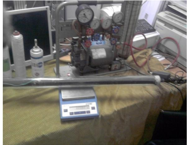
Fig. 4.6.8 Pesé de la masse du fluide pressurisé dans les tubes. (Double pesée)
