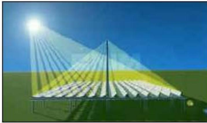
Fig.1.32 Principe de fonctionnement d'un système de concentration à miroirs de Fresnel [39]
