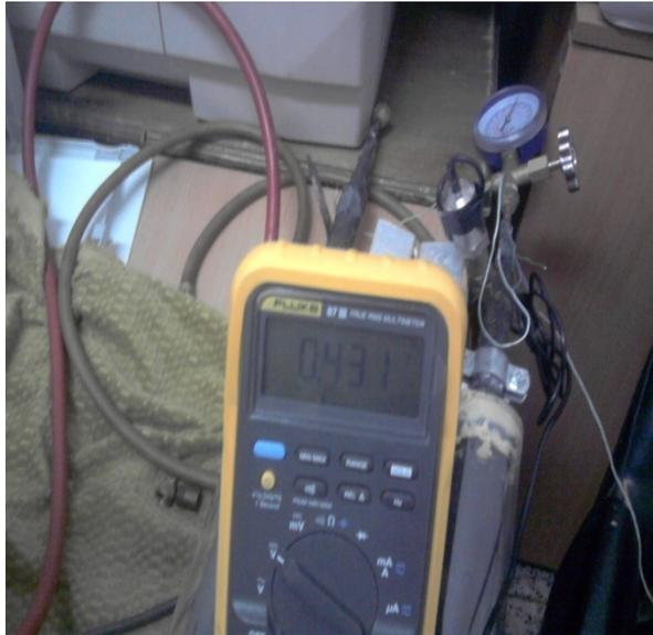
Fig. 4.6.13 Lecture de la pression sur le multimètre Fluke
