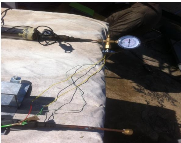
Fig.4.4.3 Connexions des thermocouples par les câbles de compensations
